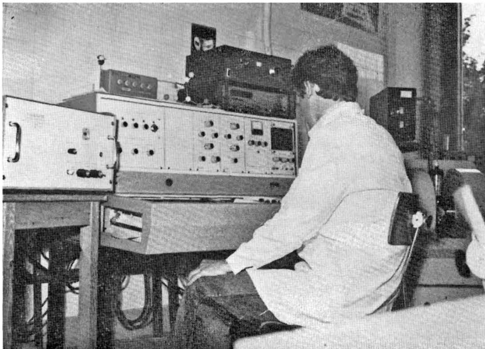
2. ábra: Elektron spin rezonancia készülékünk (Varian).
